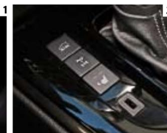
1 Cuadro parcialmente analógico, con un diseño algo sobrecargado y desfasado, pero completo en información. 2 El modo de conducción Rough Mode y el bloqueo del diferencial trasero se activan con estos botones. 3 Pantalla táctil de 9" con controles físicos y un multimedia sencillo, pero eficaz, bien conectado y con datos todoterreno.
